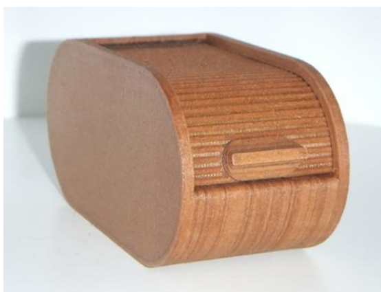
Рисунок 4 - Модель, изготовленная из Laywoo-D3. Изменение температуры экструзии позволяет добиваться разных оттенков и имитировать годовые кольца
