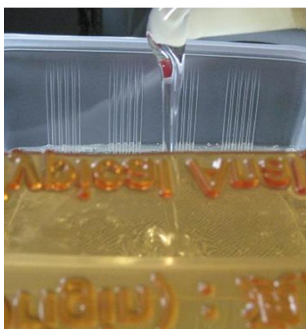
Рисунок 18 - Фотополимерная смола заливается в кювету
