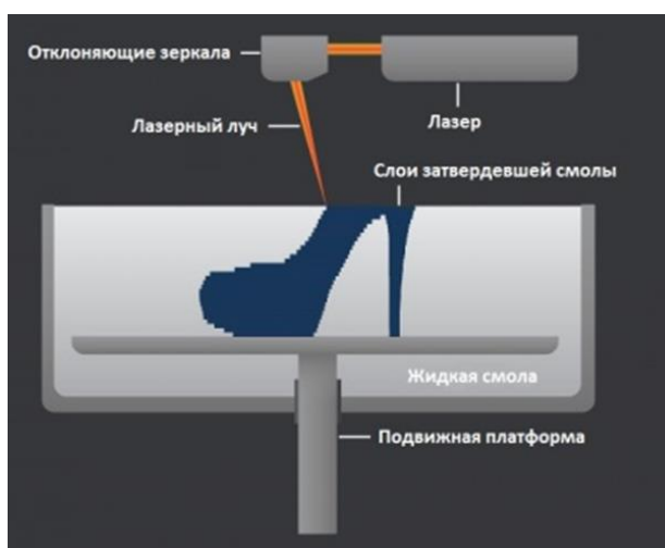
Рисунок 1 - Схема работы SLA-принтера
