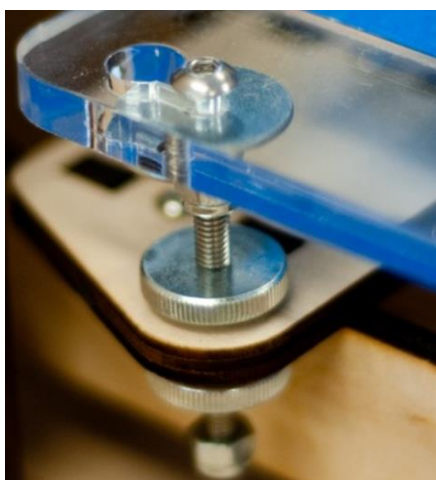
Рисунок 9 - Калибровочный винт рабочей платформы, покрытой синим малярным скотчем
