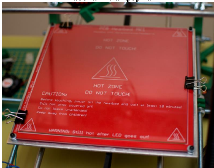
Рисунок 8 - Подогреваемая платформа, накрытая съемным стеклянным рабочим столиком
